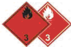
N°3 Danger de feu (matière liquide inflammable)
