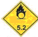
N°5.2 Peroxyde organique Danger d'incendie
